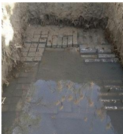
Fig.4. Conservation des éprouvettes dans l'eau rémontée
